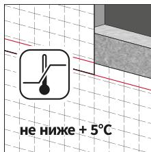
**9.** Монтаж рекомендуется выполнять при температуре **не ниже + 5°C**, т.к. при более низких температурах липкость kleящего слоя снижается, монтаж становится сложнее. Склейивание полотен и приkleивание примыканий рекомендуется производить в сухую погоду при температуре +20...+25°C. Склеваемые поверхности должны быть сухими и чистыми.
