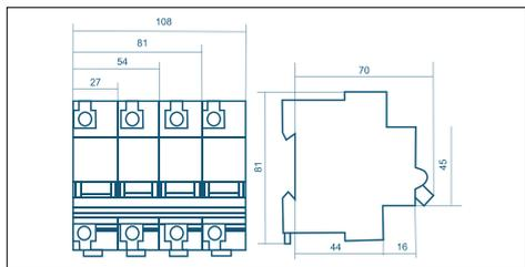
Рис. 1 – Габаритные и установочные размеры ВА 47-100
