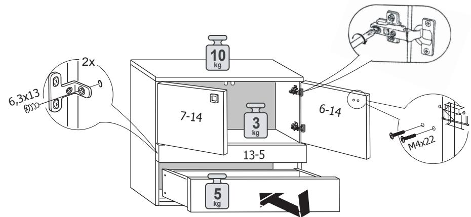
**!** При желании, закрепите ящик к направляющим дополнительным саморезом 3x16, в комплектацию саморез не входит.
