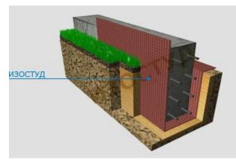
Избыточная влажность негативно сказывается не только на фундаменте здания но и на всей его конструкции в целом. Изостуд защищает фундамент от проникновения влаги и является одним из элементов системы гидроизоляции фундамента, который обычно применяется совместно с обмазочной или наплавляемой гидроизоляцией.
