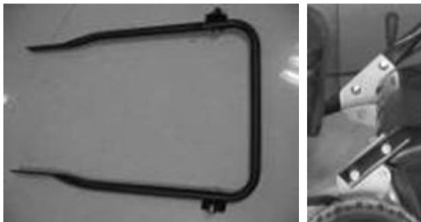
2) Установите верхнюю ручку на нижнюю ручку. Ослабьте две винтовые гайки на нижней ручке, как показано на рисунке ниже, а затем установите верхнюю ручку на нижнюю ручку. Убедитесь, что винтовые гайки достаточно плотно затянуты.
