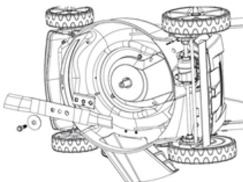
**ВНИМАНИЕ!** Производитель не несет ответственности за возможные повреждения, вызванные нарушением балансировки ножа. Категорически запрещается использовать изделие с погнутым, тупым или имеющим повреждения режущим ножом.
