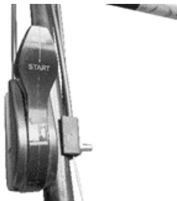
Не рекомендуется вытягивать шнур стартера на всю длину, а также резко отпускать его при повторной попытке завести двигатель. Удерживая рукоятку, плавно верните её в исходное положение. Если двигатель не запустился после 3-х рывков, отпустите рычаг выключения зажигания, подкачивайте топливо праймером\* и повторите процесс запуска. После того, как двигатель заведется, прогрейте его в течение 1-2 минут и приступайте
