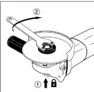
**Внимание!** Запрещается пользоваться кнопкой-фиксатором для остановки вращающегося шпинделя. Это может привести к повреждению устройства!
