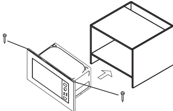
1. Поместите микроволновую печь в горизонтальном положении, отступив одинаковое расстояние до края с двух сторон. Затем вставьте болт (деталь 1) в верхней части микроволновой печи и вкрутите его в корпус.
