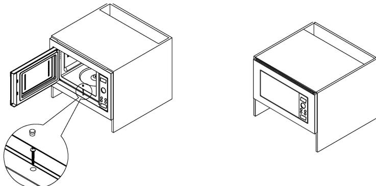
2. Откройте микроволновую печь, зафиксируйте болт (деталь 3) и вкрутите его в корпус, затем установите крышку болта.
