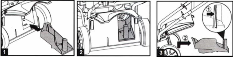
При мульчировании выполняется стрижка газона и одновременное измельчение скошенной травы с помощью специальной мульчирующей заглушки. При установке мульчирующей заглушки срезанные стебли травы нарезаются на очень малые части, которые затем равномерно распределяются по всей поверхности газона.
