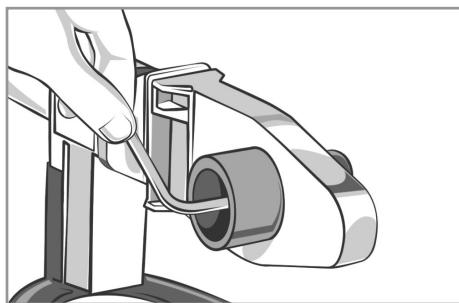
6.1.3 При помощи шестигранного ключа зафиксируйте насадки на нагревательном элементе. Убедитесь, что насадки
