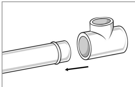
**ПРИМЕЧАНИЕ:** Не следует вдвигать пластиковую трубу в фитинг слишком глубоко, наплыв не должен уходить дальше края фитинга. В противном случае это может привести к сужению или даже к закупориванию трубы.
