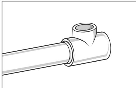
**ВНИМАНИЕ!** При охлаждении поворачивание трубы/фитинга не допустимы. В противном случае соединение может получиться не герметичным и не прочным.
