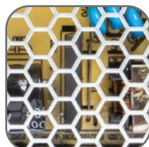
Вентиляционные отверстия для луч- шего теплоотвода
