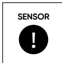
Означает, что пыль блокирует всасывание. Необходимо снять телескопическую трубку для проверки и очистки от пыли всасывающего отверстия
