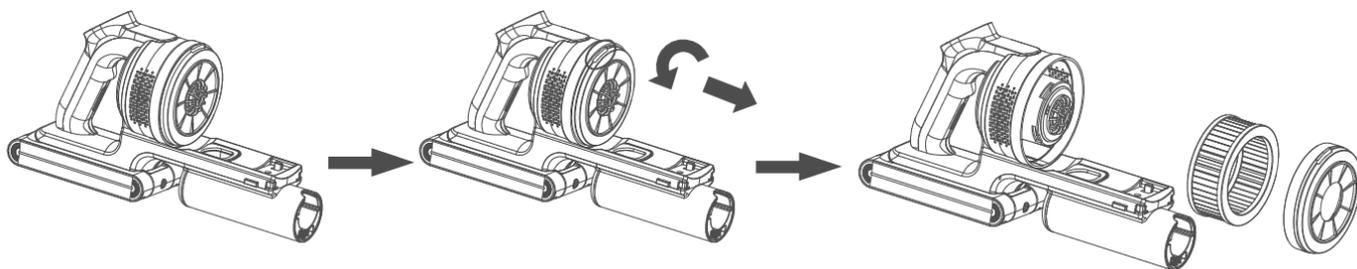
Снимите пылесборник с корпуса (см. предыдущую инструкцию по снятию).
