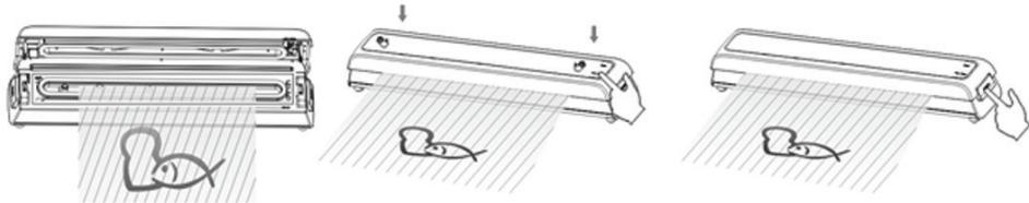
Перед следующим вакуумированием сделайте перерыв на 40 секунд для охлаждения запечатывающего элемента.
