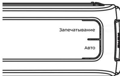
**Запечатывание** — запечатывает пакет. Повторное нажатие на кнопку во время процесса прерывает запечатывание.
