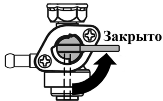
Рис. 12 Топливный кран закрыт
