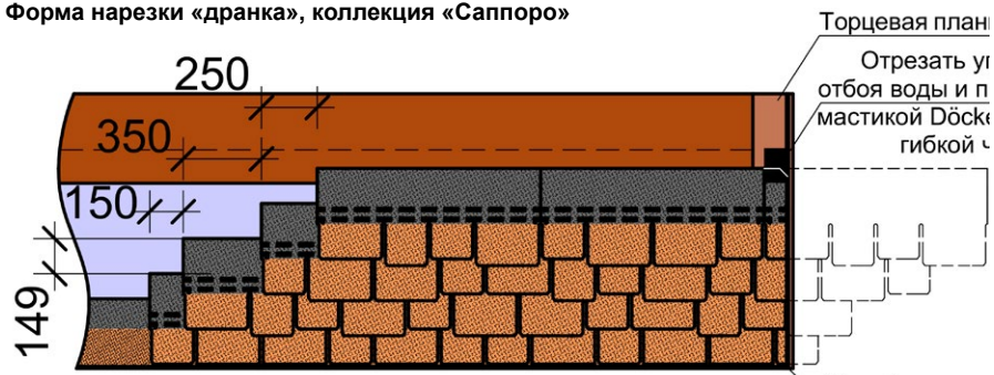
Рис. 24. Схема смещения гонтов по горизонтали и вертикали.
