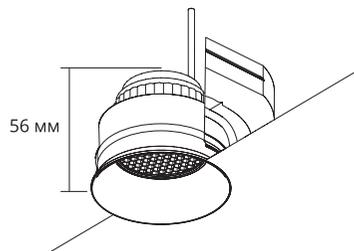
85 мм – Высота светильника в сборе с лампой MR16 GU10
