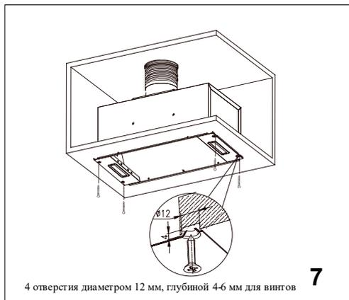
4 отверстия диаметром 12 мм, глубиной 4-6 мм для винтов
