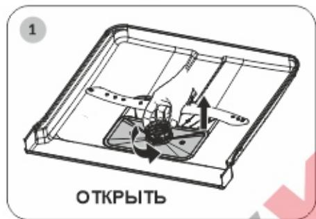
2. Фильтр мелкой очистки можно снять. Фильтр грубой очистки может быть отсоединен от основного фильтра аккуратно сжимая вкладки сверху и вытаскивая это.
