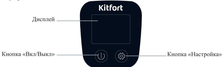
**Кнопка «Вкл/Выкл»** включает и выключает су-вид. После нажатия на кнопку «Вкл/Выкл» на дисплее появляются символы. После установки нужной температуры и времени **регулятором (колесико)**, который находится на задней части прибора, необходимо нажать повторно на кнопку «Вкл/Выкл», чтобы прибор начал работу. Вода начнет циркулировать в чаше.
