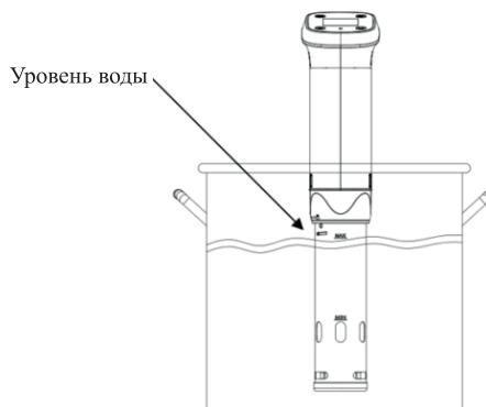
5. Подключите прибор к сети питания. Прозвучит звуковой сигнал. Нажмите и удерживайте в течение 5 секунд кнопку «Вкл/Выкл». На дисплее появятся в верхней строке — настраиваемая температура приготовления (по умолчанию 60 °C), в средней части дисплея — текущая температура воды, в нижней части дисплея слева — символы «00:00» (настраиваемое время приготовления), а справа — символы «00:00» (время работы прибора).
