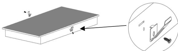
**Установка варочной панели в кухонную мебель:** Вставьте варочную панель в шкаф/столешницу, как показано на рисунках ниже. Зажимы по бокам надежно закрепят варочную панель.
