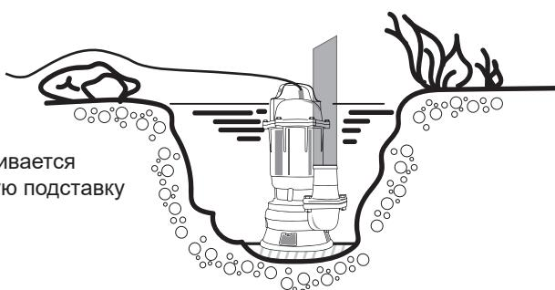
При беспрерывном режиме эксплуатации перед установкой насоса необходимо удалить из колодца шлам, гравий и тп.
