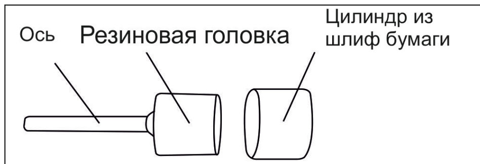
Рис.6 Установка цилиндра из шлиф бумаги
