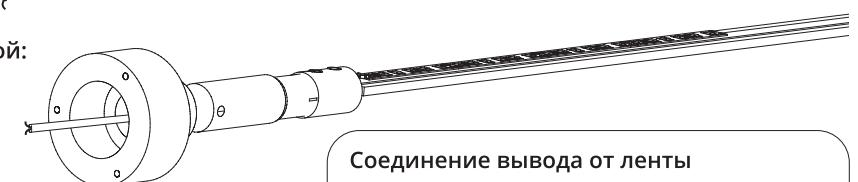
Соединение вывода от ленты с проводом питания можно разместить в корпусе стенного крепления
