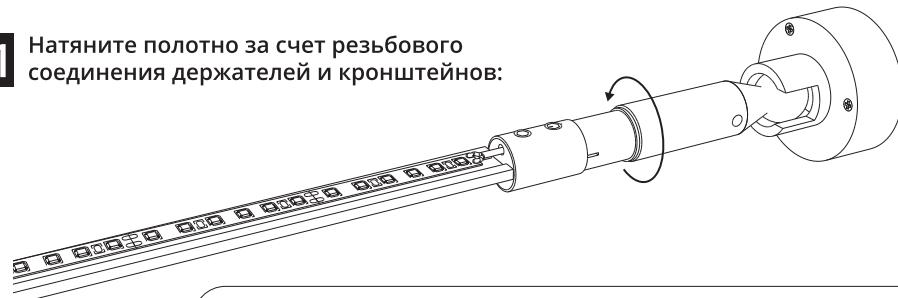
Корректировка направления светового потока осуществляется вращением кронштейнов в месте шарнирного соединения со стеновыми креплениями:
