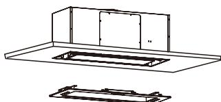
Установите панель на вытяжку, зафиксировав её 4 винтами.
