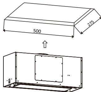
Просверлите прямоугольное отверстие 500 \* 275 мм в шкафу, переместите 2 крепежных элемента внутрь на максимальное расстояние, затем установите вытяжку в прямоугольное отверстие (зажимные части при этом должны быть выше, чем панель шкафа), затем сдвиньте крепежный элемент к внешнему краю.
