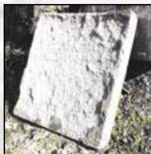
Панели, армированные сеткой, без включения волокон Степень огнестойкости – не менее 15 минут
