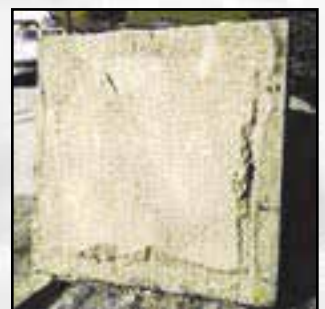
Панели, армированные полипропиленовыми волокнами Степень огнестойкости – не менее 120 минут
