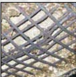
Панели, армированные сеткой, без включения волокон Степень огнестойкости – не менее 15 минут
