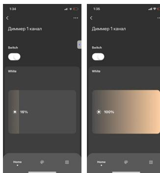
② Регулировка яркости и цветовой температуры светодиодной ленты MIX контроллером A70C-02CH-WF
