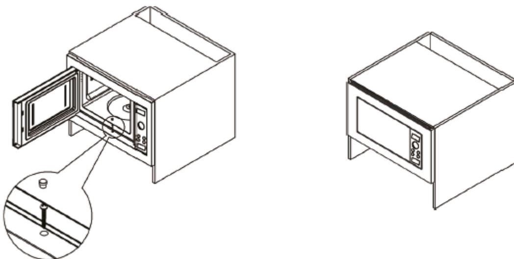
Откройте микроволновую печь, установите болт (3) и закрутите его в шкаф, затем установите заглушку для винта.
