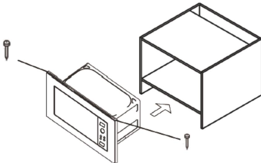
Вставьте микроволновую печь в нишу, удерживая ее в вертикальном положении, и проверьте, чтобы расстояние с обеих сторон было одинаковым. Затем зафиксируйте болт (1) на верхней части микроволновой печи и закрутите его в шкаф.
