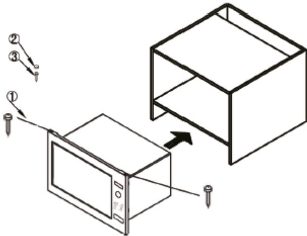
1. Крепежный болт: 2 шт. (размер: М3х20 мм)
