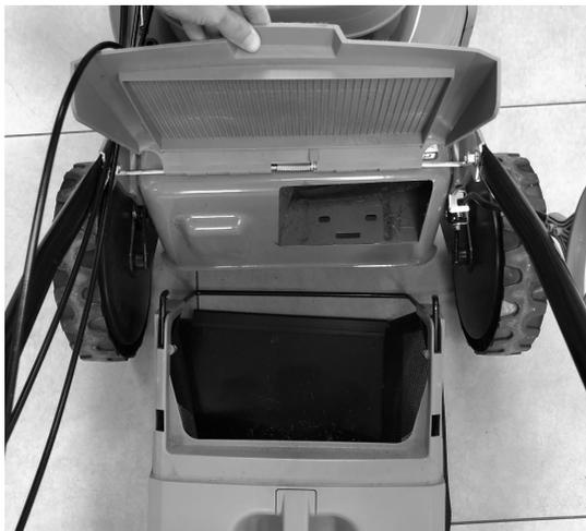
Поднимите заднюю крышку вверх, установите травосборник на место и опустите заднюю крышку как показано на рис. 5
