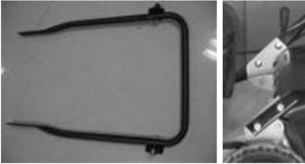
2) Установите верхнюю ручку на нижнюю ручку. Ослабьте две винтовые гайки на нижней ручке, как показано на рисунке ниже, а затем установите верхнюю ручку на нижнюю ручку. Убедитесь, что винтовые гайки достаточно плотно затянуты.
