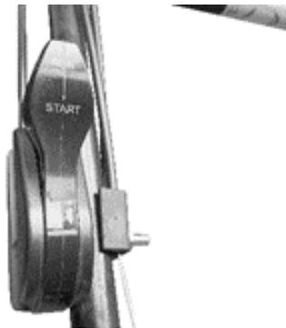
Не рекомендуется вытягивать шнур стартера на всю длину, а также резко отпускать его при повторной попытке завести двигатель. Удерживая рукоятку, плавно верните её в исходное положение. Если двигатель не запустился после 3-х рывков, отпустите рычаг выключения зажигания, подкачайте топливо праймером\* и повторите процесс запуска. После того, как двигатель заведется, прогрейте его в течение 1-2 минут и приступайте
